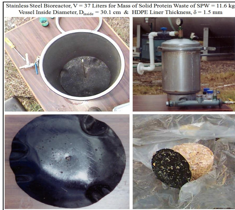
الشكل 1: مراحل تجربة هضم المُخلفات البروتينية الصلبة وحالة تصلد الغشاء البوليمري بعد تفريغ العبوة [1].
