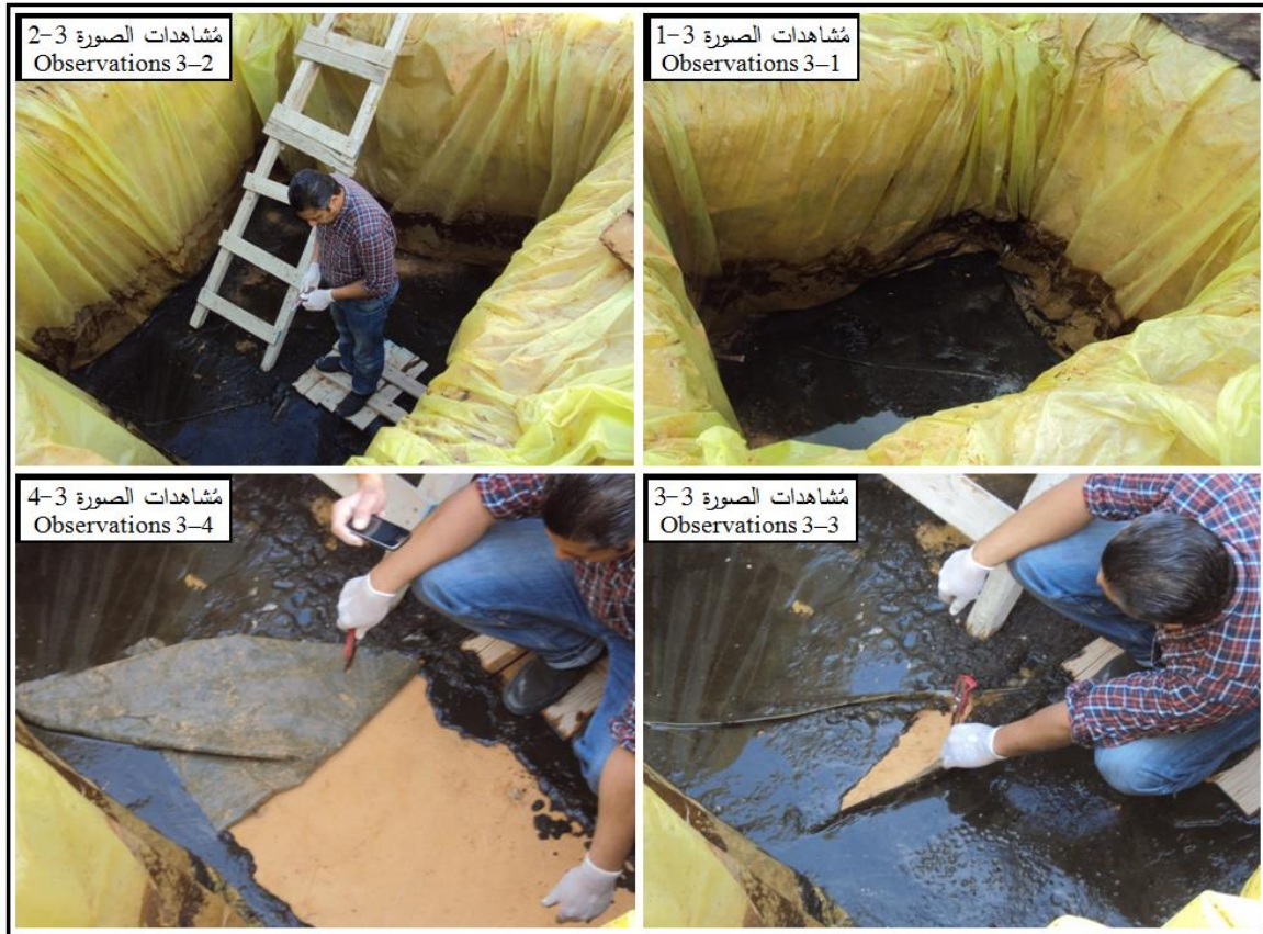
الشكل 3: المُشاهدات العينية لحالة البطانة الجيوبلاستيكية في البئر التجريبي بعد تفريغ عبوة المياه السوداء.
