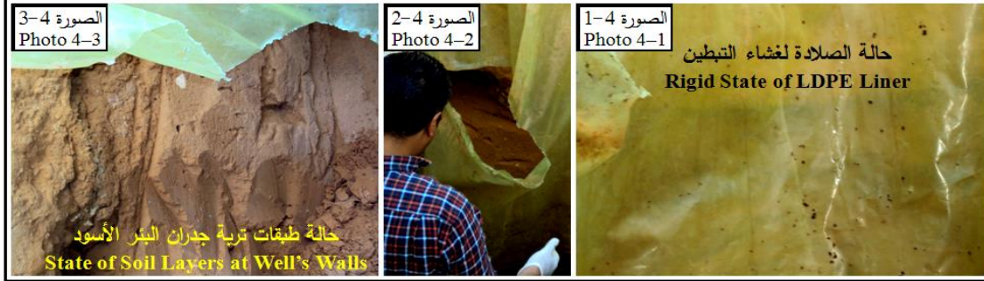
الشكل 4: مشاهدات تصلد الجزء الجداري لغشاء التبتين وحالة طبقات التربة الملامسة لجدران الغشاء.
